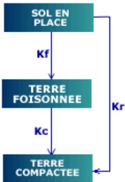
Le coefficient de foisonnement,  $K_f$  permet de connaître le volume de terre foisonnée à partir du volume de terre en place.
