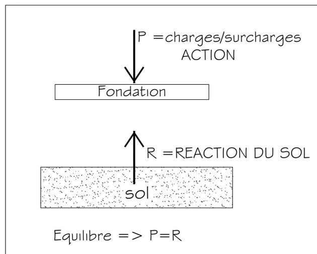
Pour que le système sol – fondation soit en équilibre il faut que la force de réaction du sol de fondation R soit égale à la force transmise par la fondation.
