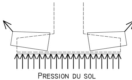
On voit donc la nécessité de disposer un ferrailage sur le coté bas de la paillasse de la semelle isolée.
