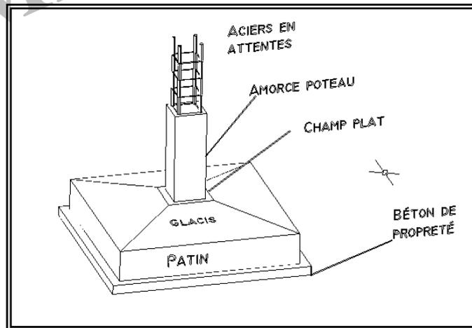
**Béton de propriété :** C'est une couche de béton faiblement dosée servant à surfacier le fond de fouille qui peut présenter des irrégularités suite aux travaux de terrassements .c'est sur cette couche que l'on disposera les cales (petits cubes en bétons e dimensions 5cm x 5cm) sur lesquelles sera posé le ferrailage de a semelle voir figure suivante.
