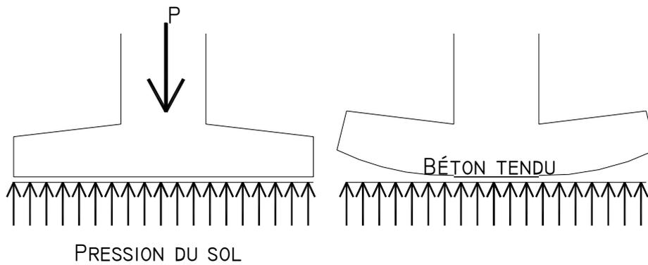
Nous remarquons que sous l'influence de la pression du sol les bords de la semelles subissent une flexion vers le haut. Les fibres basse du béton subissent alors une traction. Comme le béton résiste très mal à la traction si des dispositions particulières ne sont pas prises, la semelle risque de casser. Voir figure
