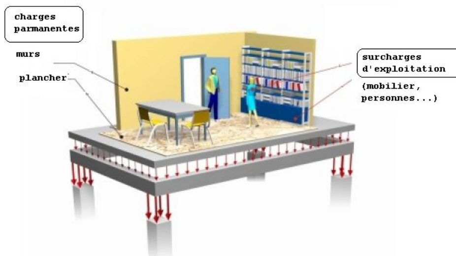
Figure 1 répartition de charges sur les poutres de plancher.
